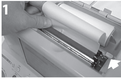
Leva printer in posizione di stampa (abbassata).
