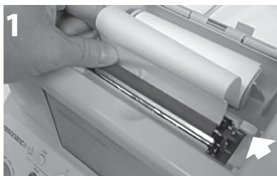
Levier de l'imprimante verrouillé en position d'impression (vers le bas)
